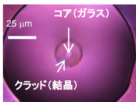
図. 結晶化ガラスファイバ素子の断面と作製した光学素子
