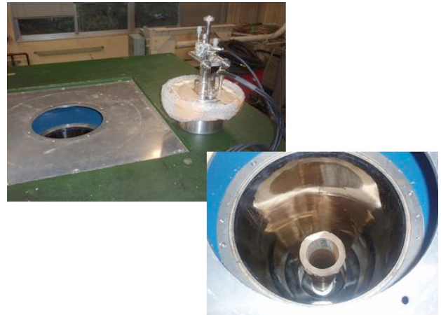
図 4 着磁装置と挿入直前のクライオスタット
