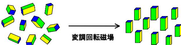
Fig. 1 変調回転磁場による2軸性結晶の3次元配向（擬単結晶化）
