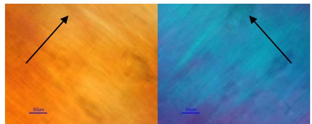
Fig. 2 ホヤ微結晶（塩酸処理）の変調回転磁場を印加したサンプルの偏光顕微鏡写真。印の方向が変調回転磁場の回転軸。
